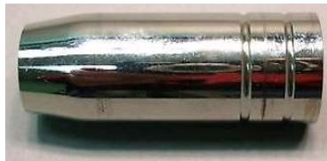
Šobe – rezervni deo pištolja, čistiti ih kako treba a ne lupati pištoljem o sto da otpadnu pucne
