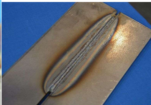
Provar – crni čelik, bez obaranja ivica (debljina 3 mm, zazor 4 mm)
