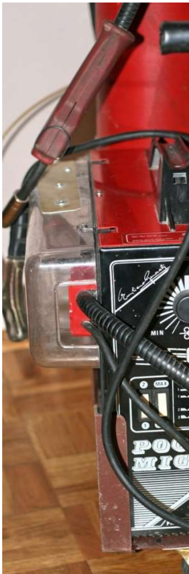
Plastični providni poklopac na dodavaču za žicu
