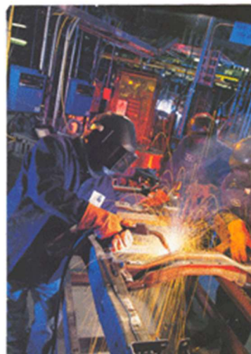
Zavarivanje automobilskih šasija u USA, MAG postupkom
