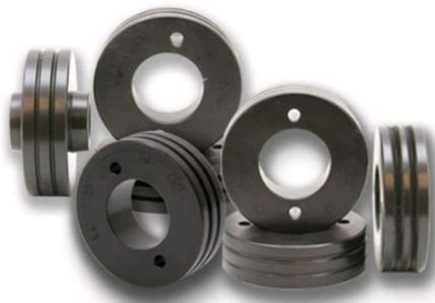
Točkići za razne prečnike žica i za razne metale (aluminijum, čelik)
